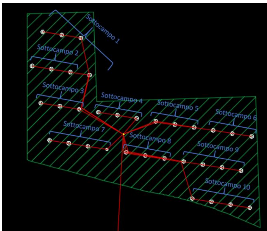
Figura 5 - Struttura del parco eolico con indicazione dei sottocampi e della stazione Off-Shore
