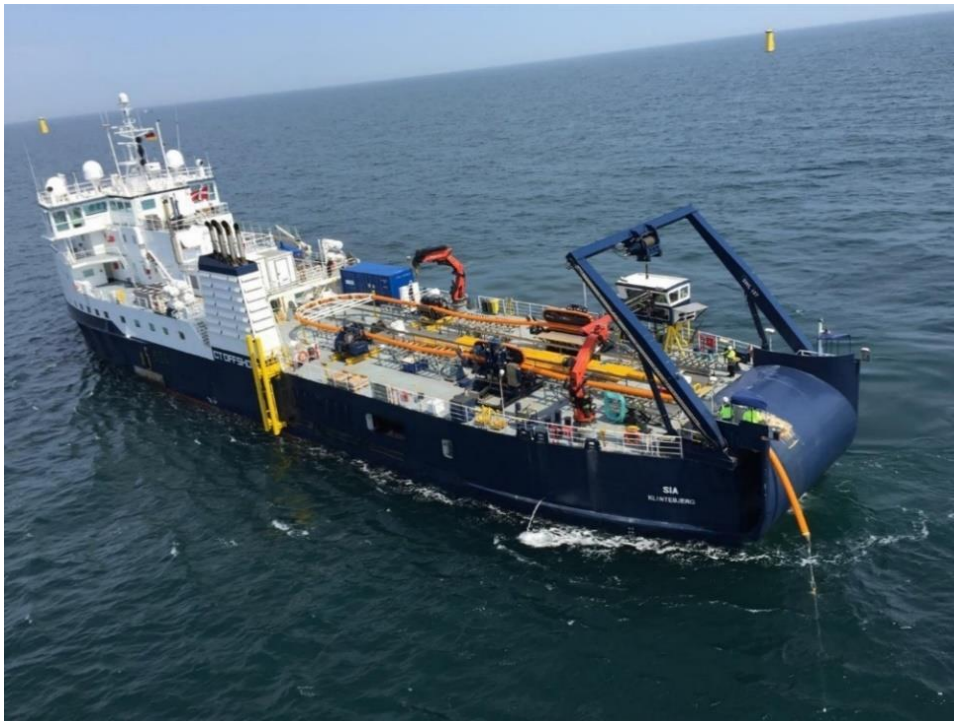
Figura 2.DD Illustrazione dell'installazione del cavo (Fonte: Offshore Gode-wind)
