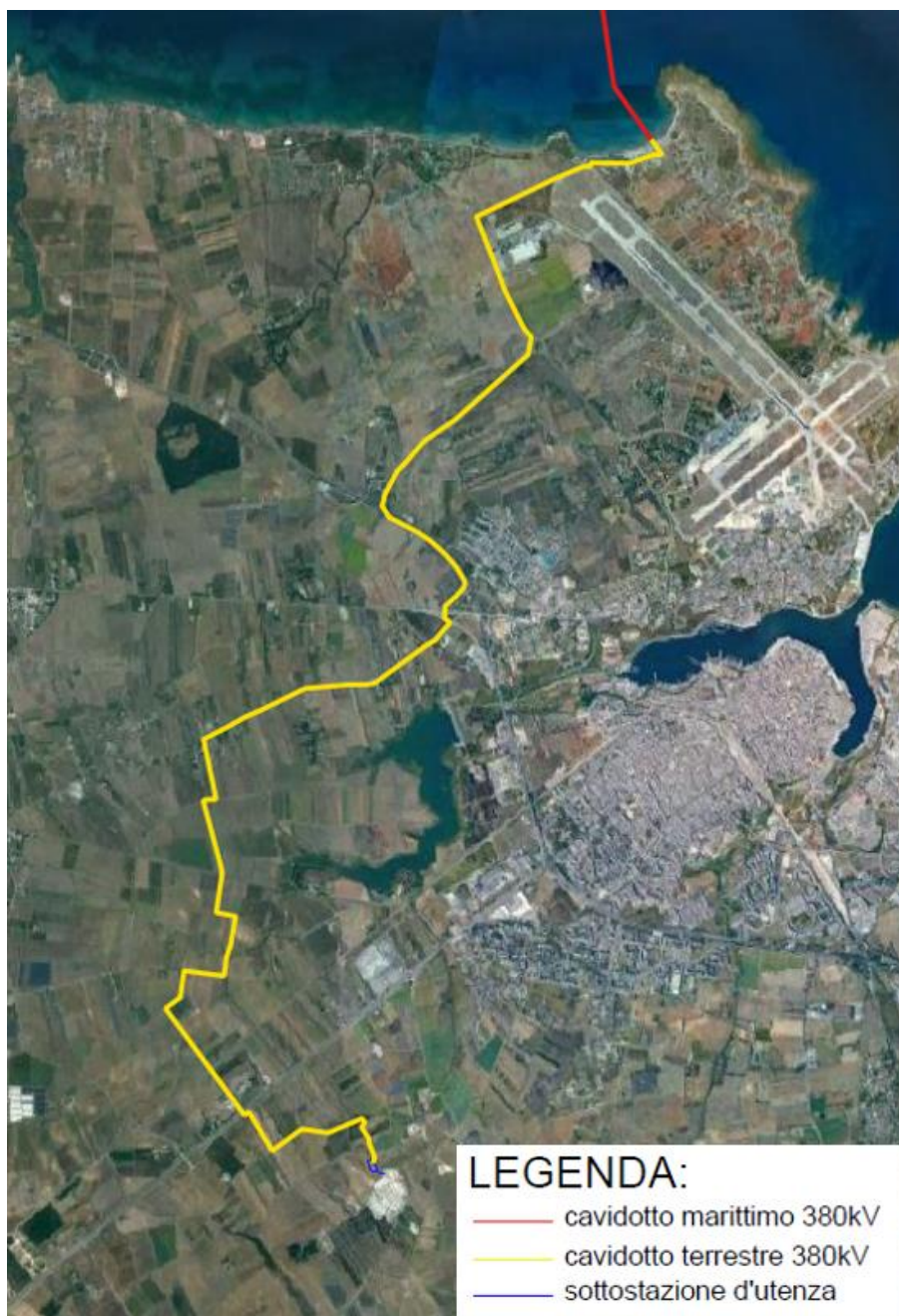
Figura 1.E Percorso terrestre dei cavi su ortofoto
