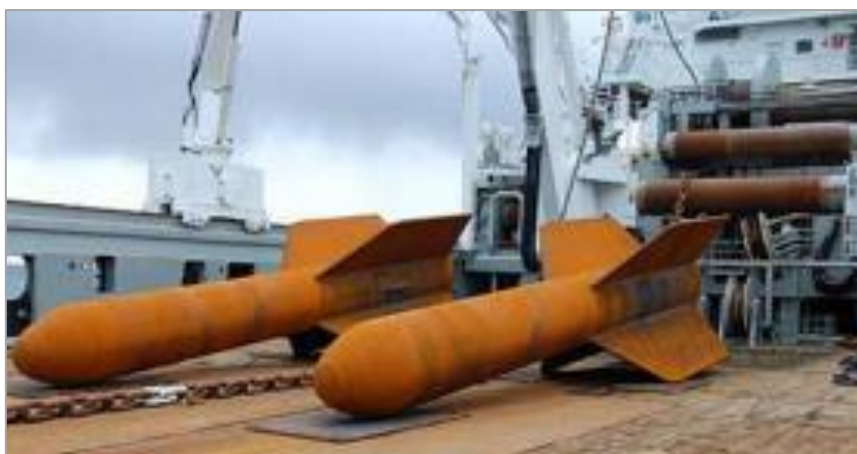
Figura 2.I Illustrazione di pali a siluro
