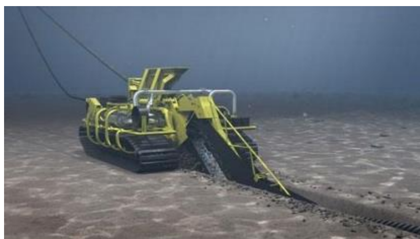
Figura 2.O Sistemi protezione dei cavi per interramento
