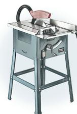
posteriormente un coltello divisorio in acciaio ed inferiormente un carter a protezione delle cinghie di trasmissione e della lama. La versione portatile presenta un'impugnatura, affiancata al corpo motore dell'utensile, grazie alla quale è possibile dirigere il taglio, mentre il coltello divisorio è posizionato nella parte inferiore.
