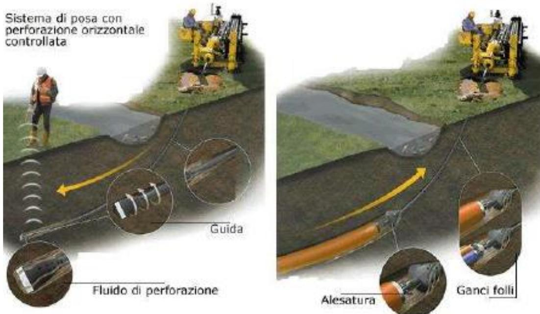
*Posa in opera tubazione con trivellazione teleguidata*
