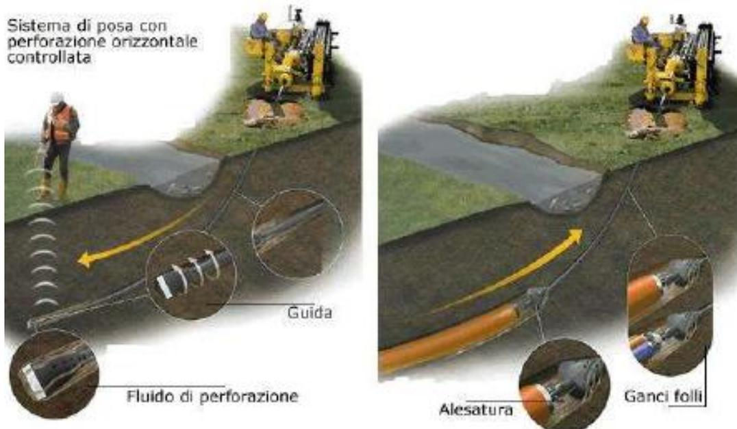
*Posa in opera tubazione con trivellazione teleguidata*
