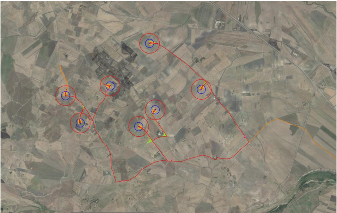
In rosso un buffer di 200 m coincidente con il valore di gittata massima
