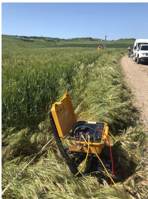
FOTO 2: postazione di energizzazione SS2
