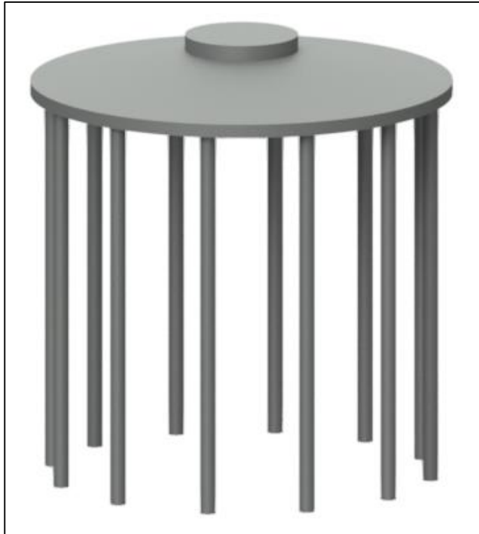
Figura 2: vista tridimensionale della fondazione dell'aerogeneratore
