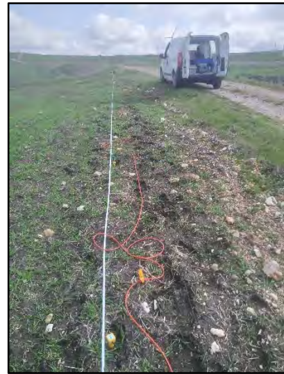
Fotografia 26 -Visione verso Sud-Est dello stendimento sismico ST07
