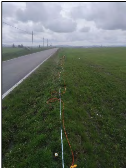
Fotografia 5 -Visione verso Sud-Est dello stendimento sismico ST02
