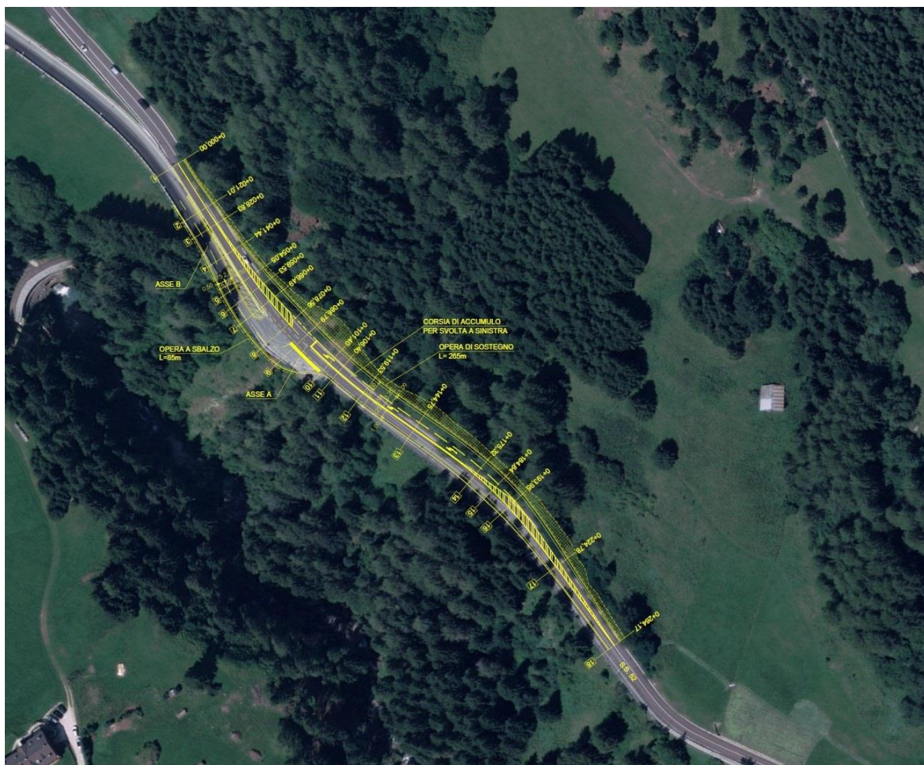
Figura 3.2 – Planimetria di progetto su ortofoto Alternativa B
