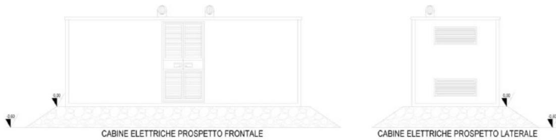
Figura 3: Posa sopraelevata delle cabine di consegna
