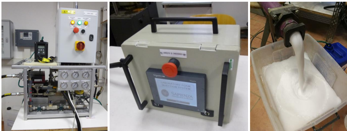
Figura 7 - Generatore di schiuma messo a punto presso il Dipartimento di Ingegneria Strutturale e Geotecnica (DISG) dell'Università di Roma "Sapienza".
