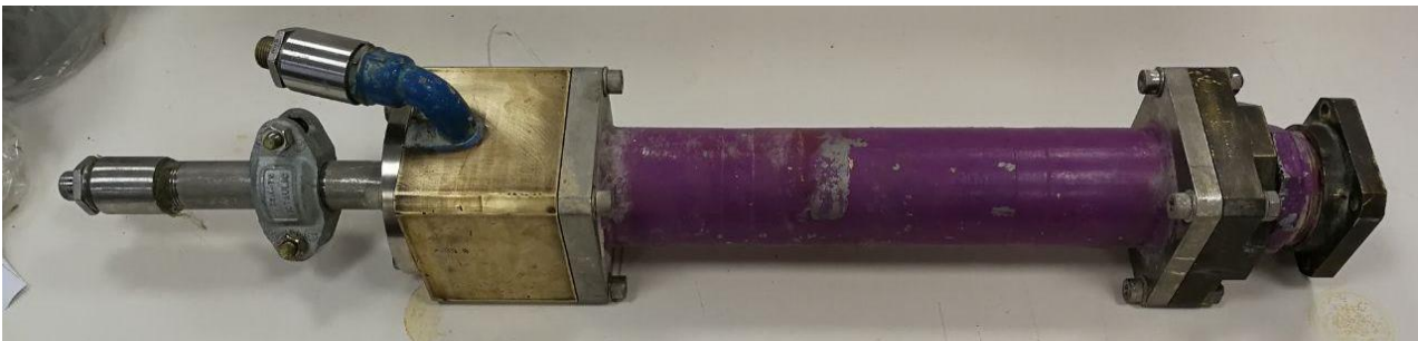
Figura 8 – Lancia di generazione della schiuma disponibile presso il Dipartimento di Ingegneria Strutturale e Geotecnica (DISG) della Sapienza utilizzata per la sperimentazione.
