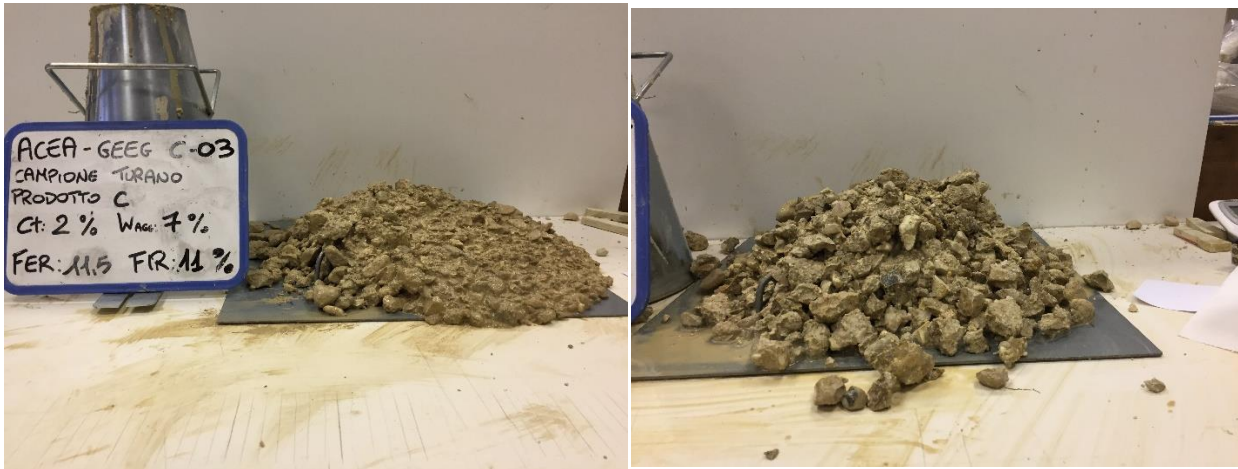
Figura 18 – Fotografie delle prove di slump eseguite su campioni di Conglomerato condizionato con prodotto ACEA C.
