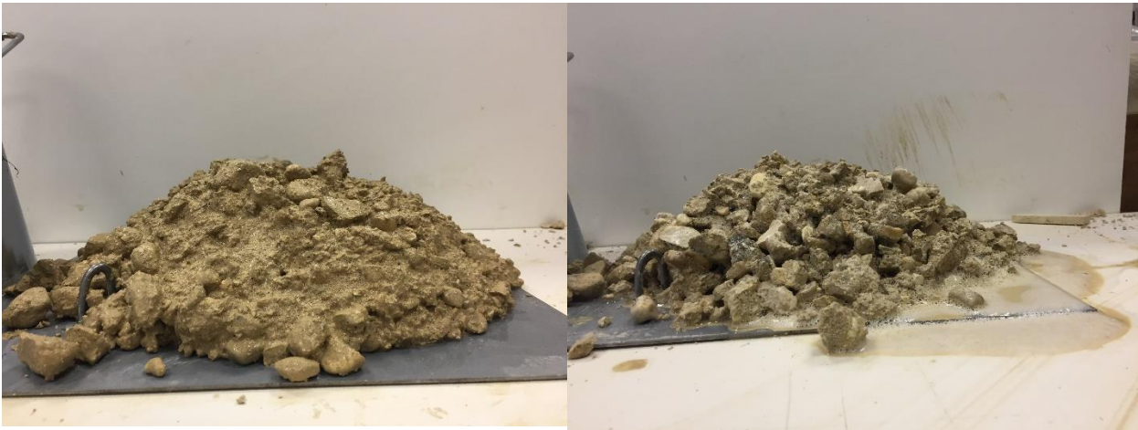
Figura 20 – Fotografie delle prove di slump eseguite su campioni di Conglomerato condizionato con prodotto ACEA F.
