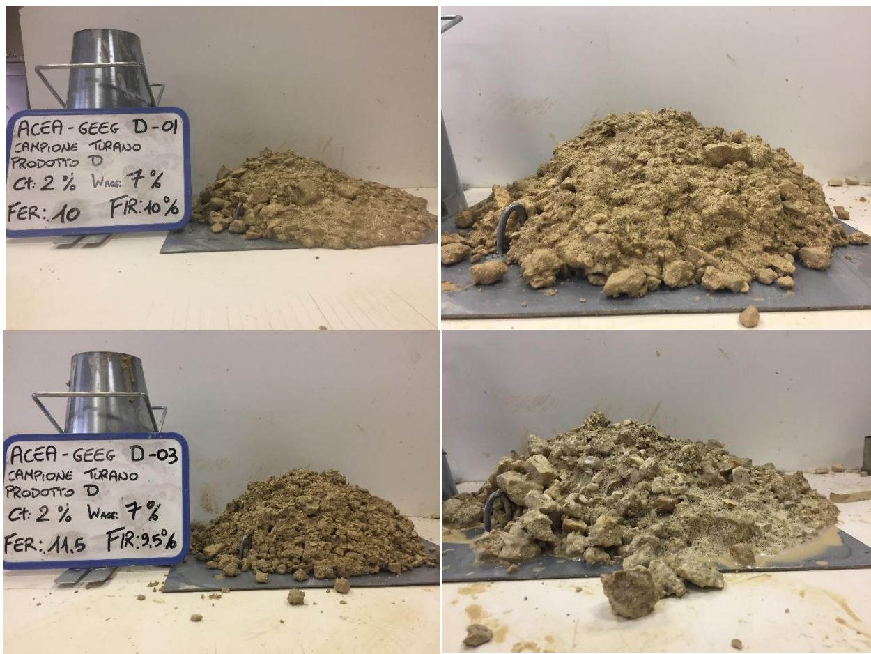
Figura 19 – Fotografie delle prove di slump eseguite su campioni di Conglomerato condizionato con prodotto ACEA D.
