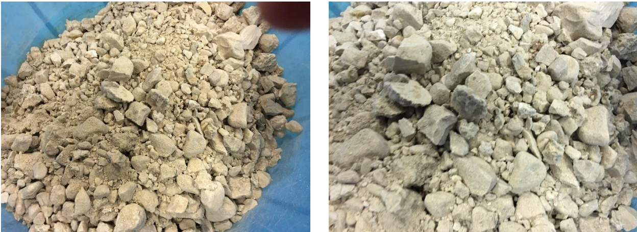
Figura 6 – Campione di conglomerato nella sua forma alterata utilizzato per lo studio.
