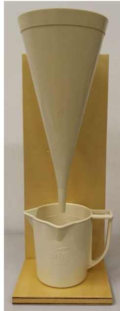
Figura 9 – Cono di Marsh per la determinazione della viscosità dei prodotti.
