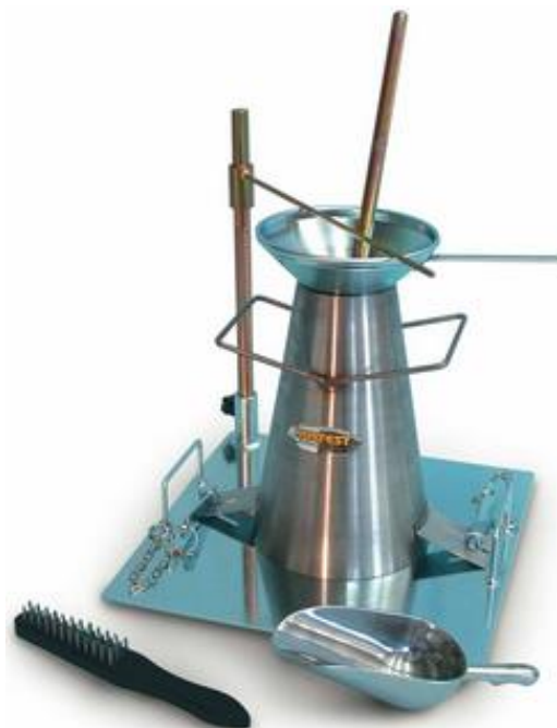
Figura 16 – Cono di Abrams e tavola a scosse utilizzati per le prove di laboratorio.
