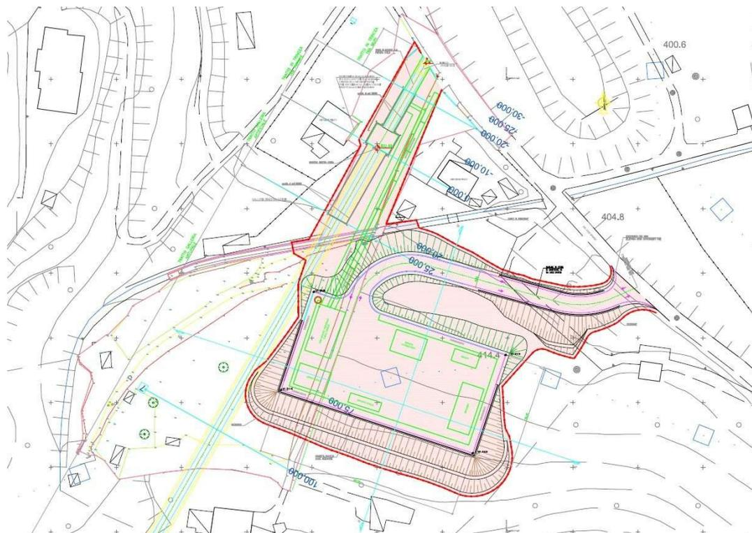
*Figura 5.26 – Area di cantiere Finestra Cotilia – Viabilità di accesso*
