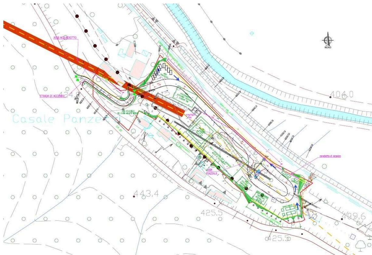
Figura 5.22 – Area di cantiere M6 – Viabilità di accesso
