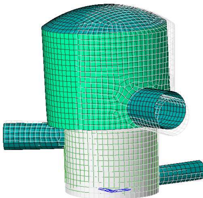
Figura 7-19 - Modo 2 Post-Operam T=0.1103\text{sec} - Massa Partecipante in dir. y 51.27%
