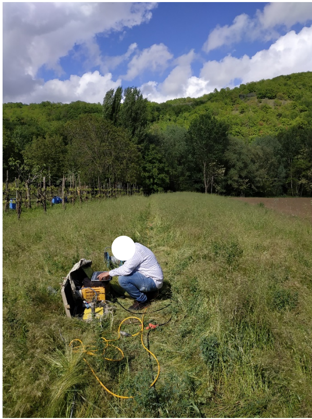
Acquisizione dati misure sismiche
