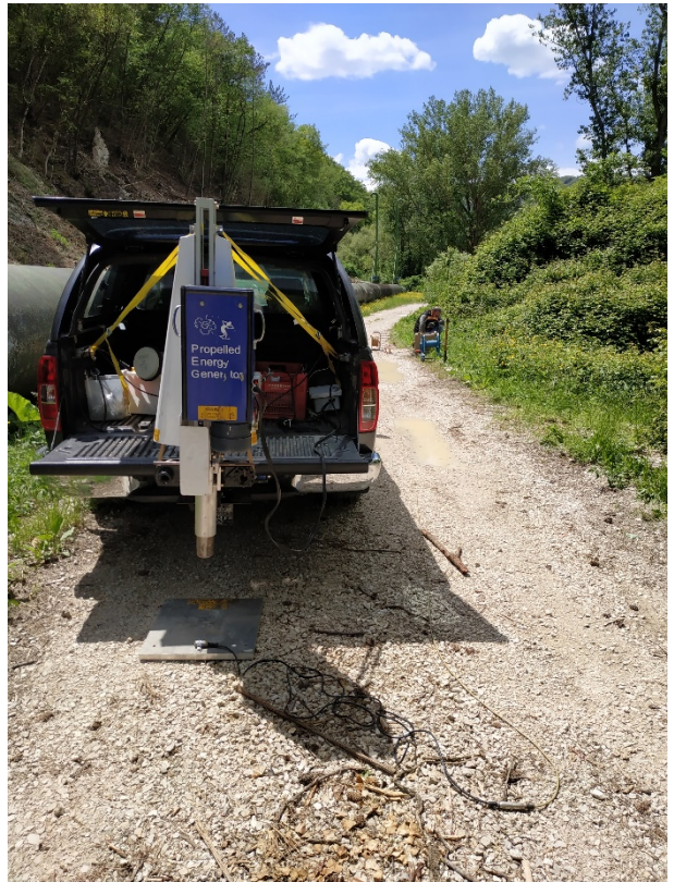
Energizzazione onde longitudinale (Onde P) con generatore ad energia propulsiva di onde sismiche "Peg40"
