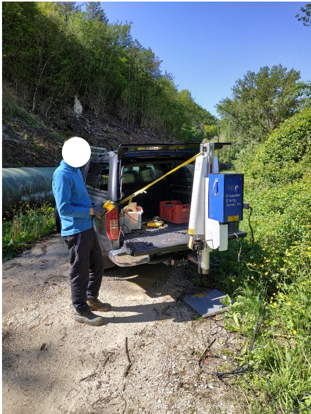
Energizzazione onde longitudinale (Onde P) con generatore ad energia propulsiva di onde sismiche "Peg40"
