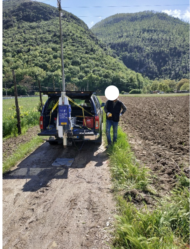
Energizzazione onde longitudinale (Onde P) con generatore ad energia propulsiva di onde sismiche "Peg40
