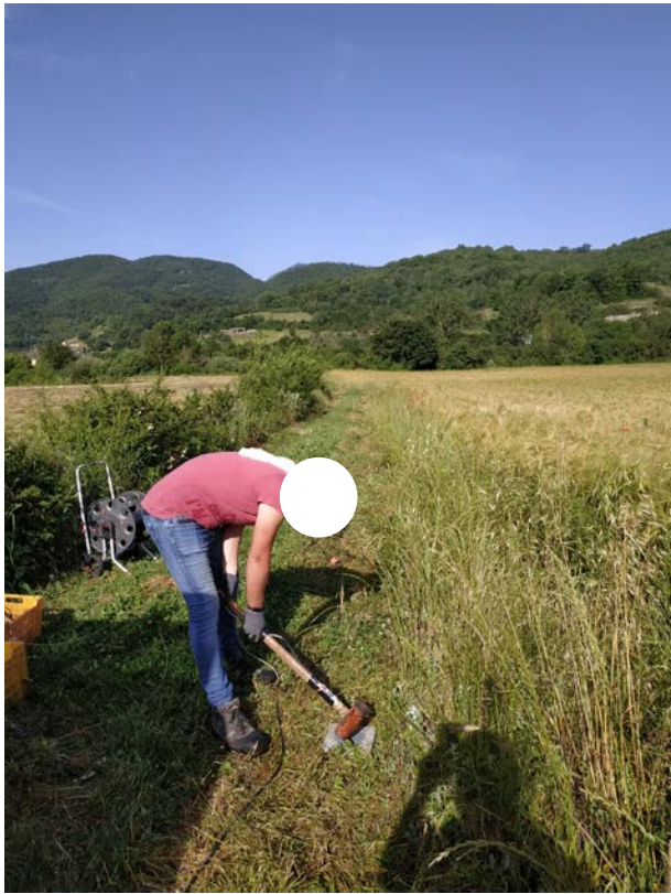
Energizzazione con mazza battente onde longitudinale (Onde P)
