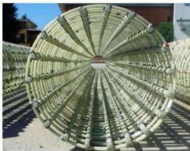
Figura 5-23 – Esempio Gabbia in vetroresina per pali
