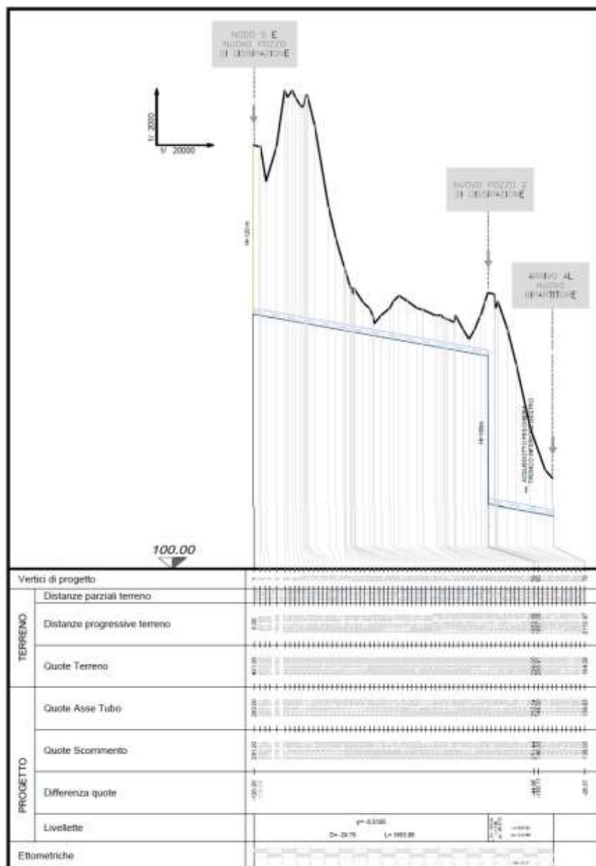
**Figura 4.5 - Planimetria e sezione di dettaglio del by-pass della centrale di Salisano**
