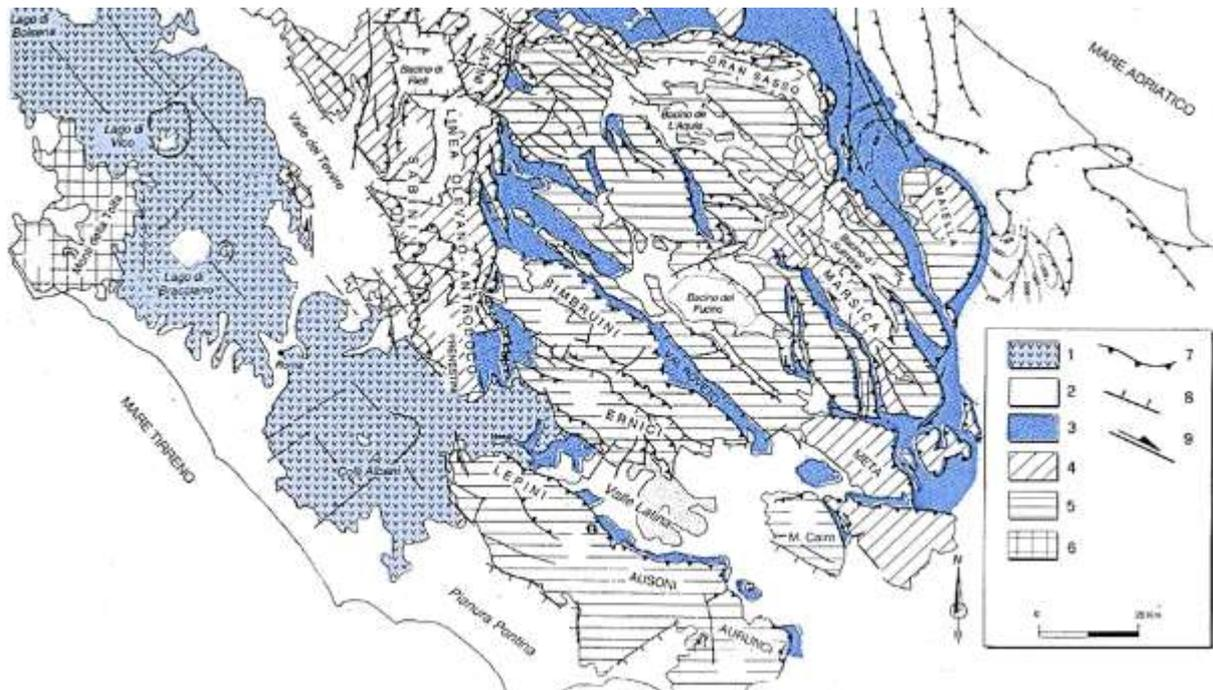
**Figura 6.1 – Zone sismogenetiche italiane Schema geologico dell’Appennino Centrale. 1-vulcaniti pleistoceniche; 2-depositi continentali plio-quadernari; 3-depositi silicoclastici mio-pliocenici; 4-depositi di transizione (dominio Sabino); 5-depositi di piattaforma Laziale-Abruzzese; 6-Complesso Tolfetano-Cerite; 7-Principali sovrascorrimenti; 8-Faglie dirette; 9-Faglie trascorrenti (da Bigi et al., 1990, modificato).**
