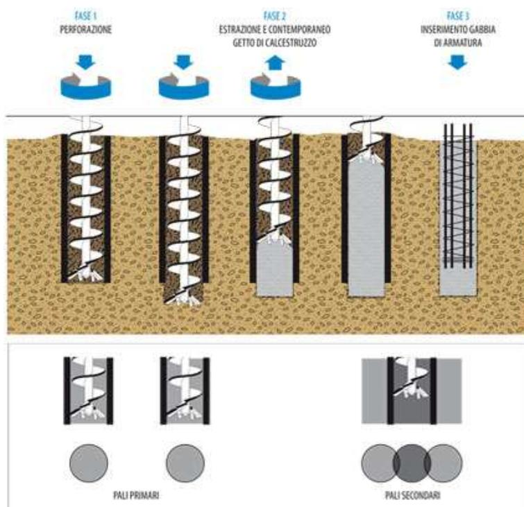
**Figura 4.3 - Schema esecutivo pali secanti**
