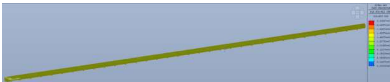
Figura 10.51 – INVILUPPO SISMA, massima tensione (Von Mises) 223 MPa
