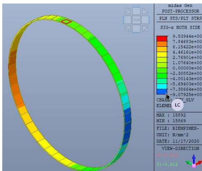
Figura 10.80 Tensioni membranali lungo l'asse della condotta
