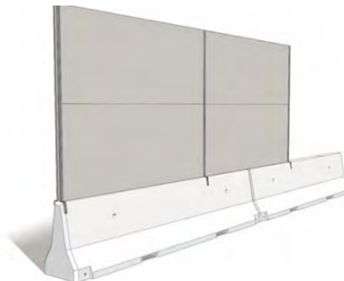
Figura 10.2 – Barriere in cls tipo New Jersey
