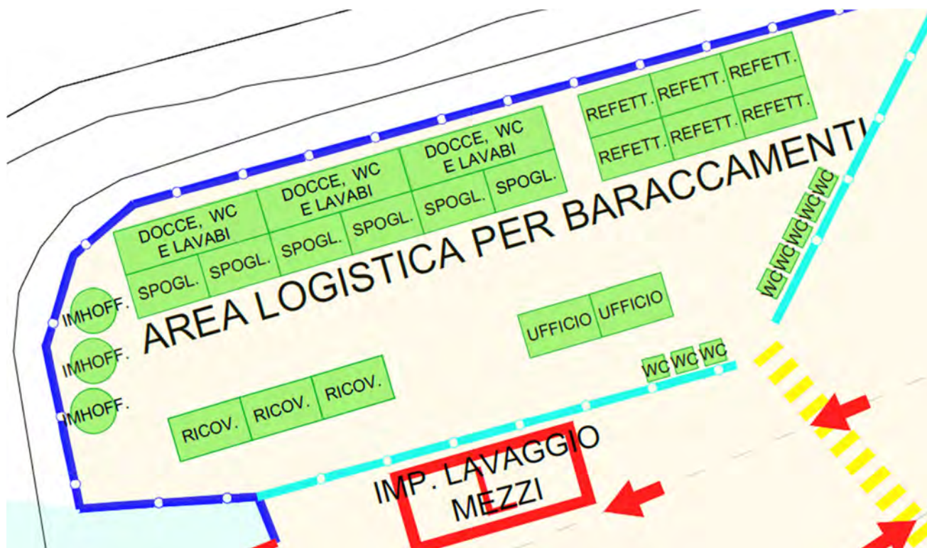
Figura 7.7 – Area logistica cantiere Sorgenti del Peschiera
