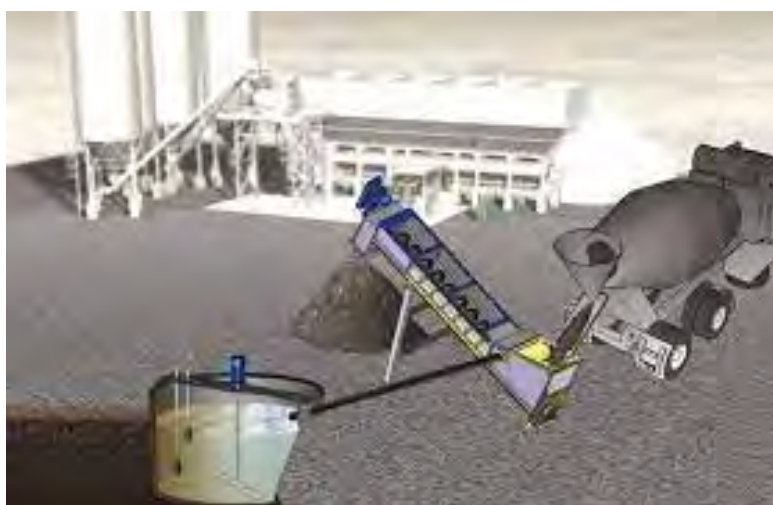
Figura 7.5 – Impianto di lavaggio betoniere
