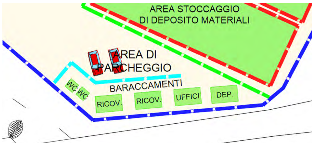
Figura 7.3 – Area logistica cantiere M1
