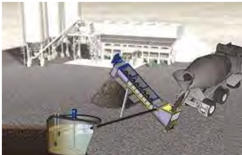
Figura 7.11 – Impianto di lavaggio betoniere
