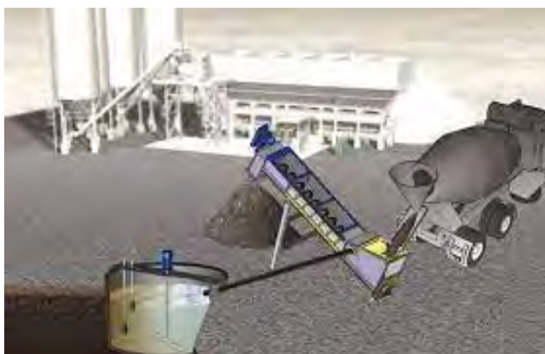
Figura 7.6 – Impianto di lavaggio betoniere
