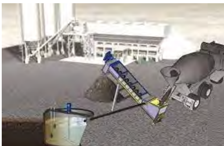
Figura 7.10 – Impianto di lavaggio betoniere
