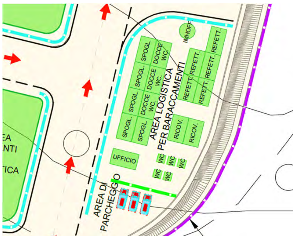
Figura 7.8 – Area logistica cantiere M5
