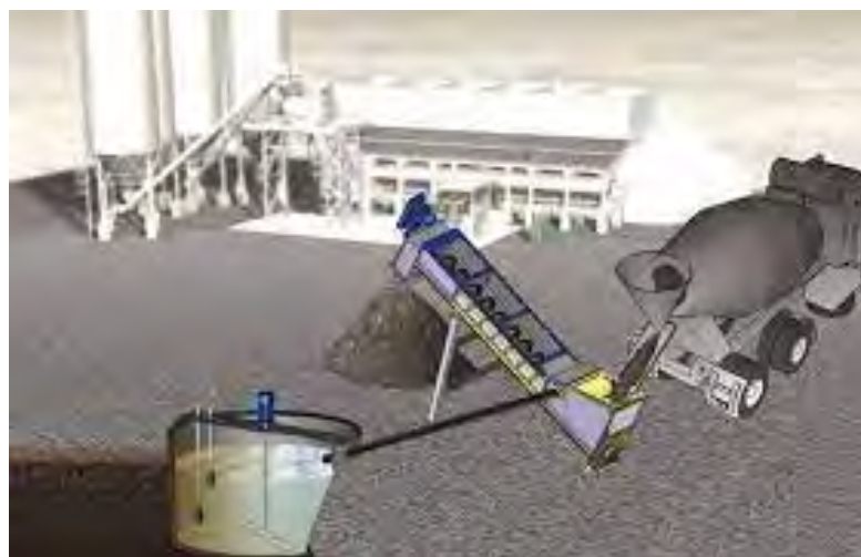
Figura 7.10 – Impianto di lavaggio betoniere
