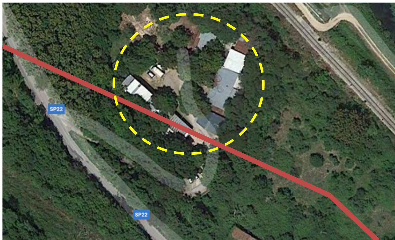
Figura 6.8 – Interferenza edifici esistenti presso uscita galleria Ponzano
