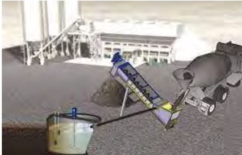
Figura 7.8 – Impianto di lavaggio betoniere
