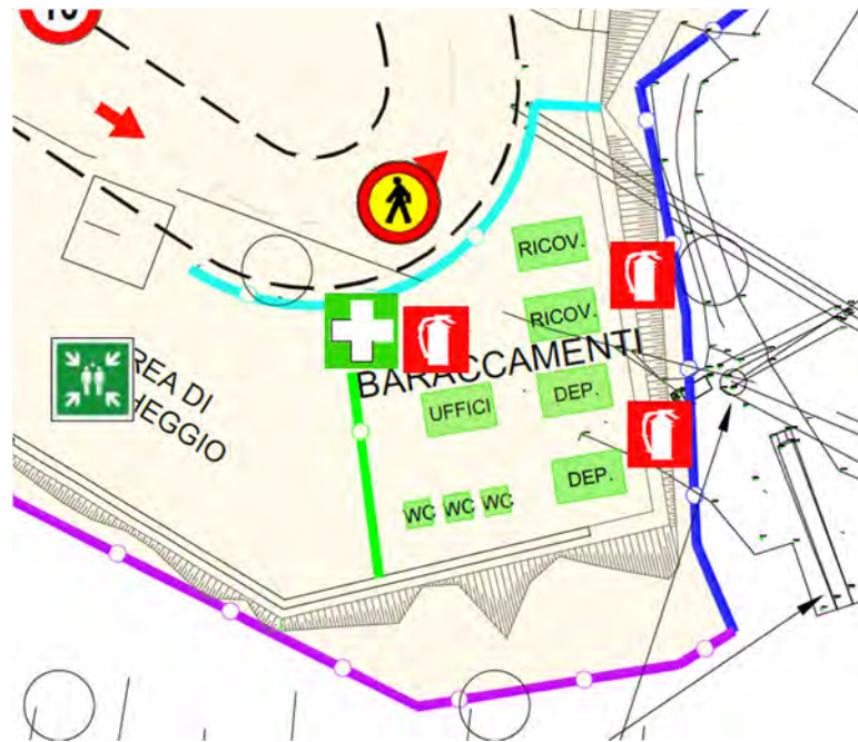
Figura 7.6 – Area logistica cantiere M6
