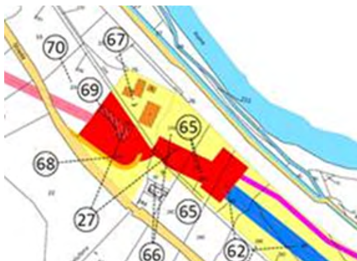
Figura 6.9 – Interferenza edifici esistenti presso uscita galleria Ponzano
