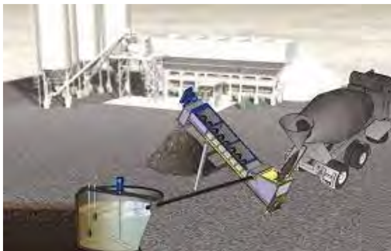
Figura 7.6 – Impianto di lavaggio betoniere
