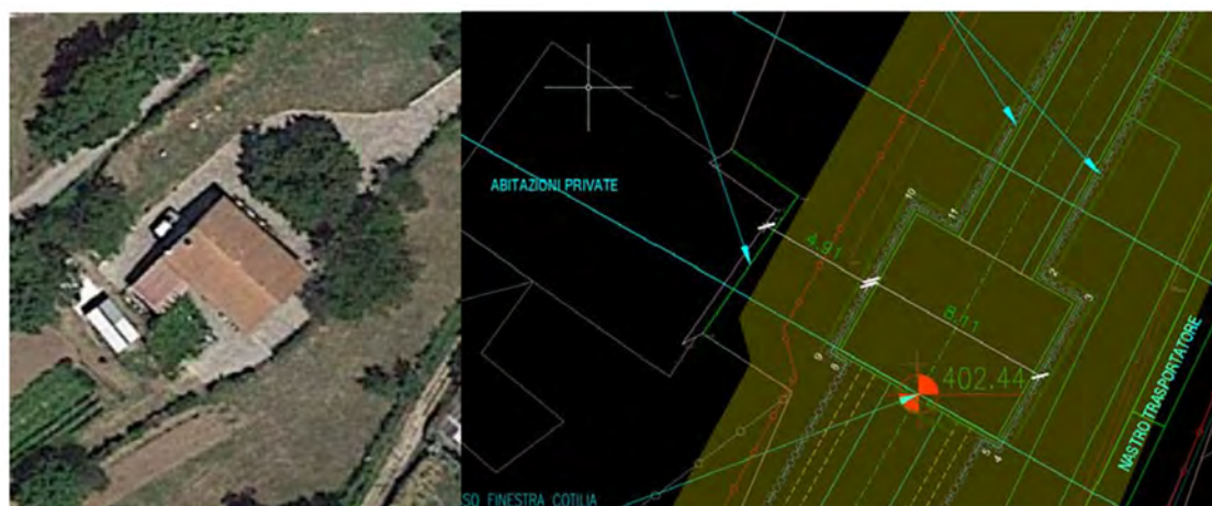
Figura 6.9 – Interferenza edificio esistente con paratia Finestra di Cotilia
