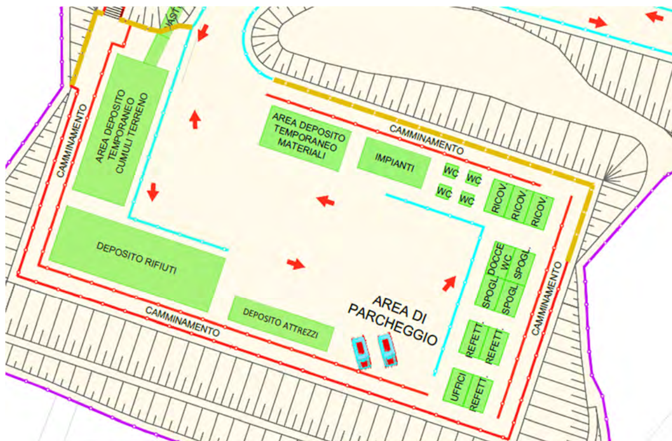
Figura 7.4 – Area logistica cantiere Finestra di Cotilia
