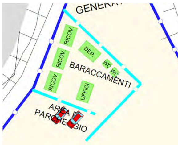
Figura 7.9 – Area logistica cantiere Turano Monte
