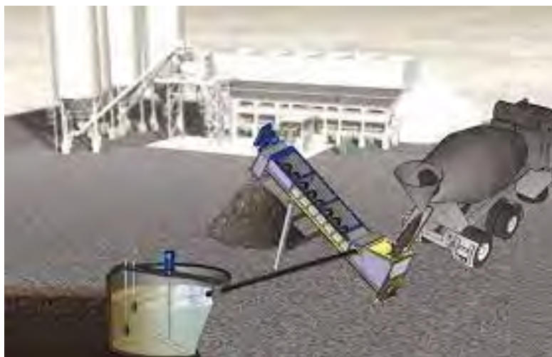
Figura 7.12 – Impianto di lavaggio betoniere
