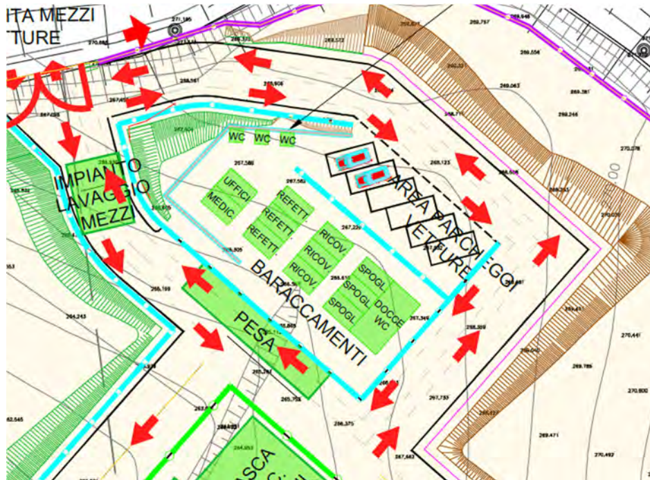
Figura 7.4 – Area logistica cantiere Pozzo 2
