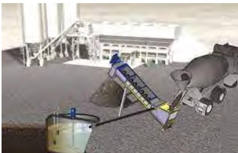
*Figura 7.8 – Impianto di lavaggio betoniere*
