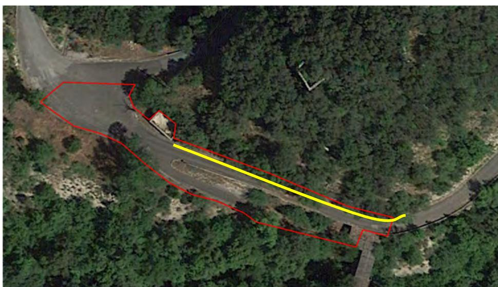
*Figura 10.2 – Tratto in cui realizzare la rete di protezione contro la caduta massi*
