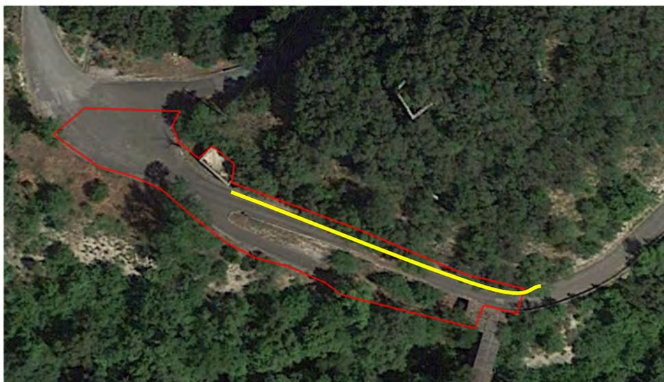
*Figura 6.6 – Tratto in cui realizzare la rete di protezione contro la caduta massi*
