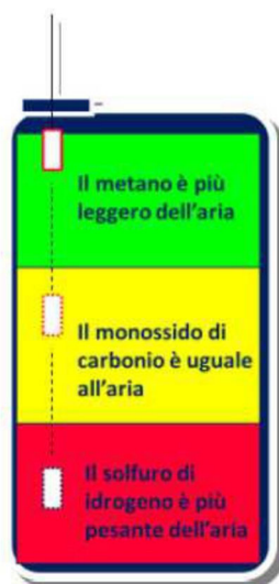
Figura 2.3 – Obbligo di verifica dell'atmosfera dell'A.S.I.C. in più punti lungo la medesima verticale.
