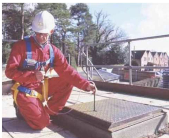
Figura 2.2 – Misurazioni preliminari dall'esterno dell'A.S.I.C. tramite strumentazione dotata di apposite sonde campionatrici
