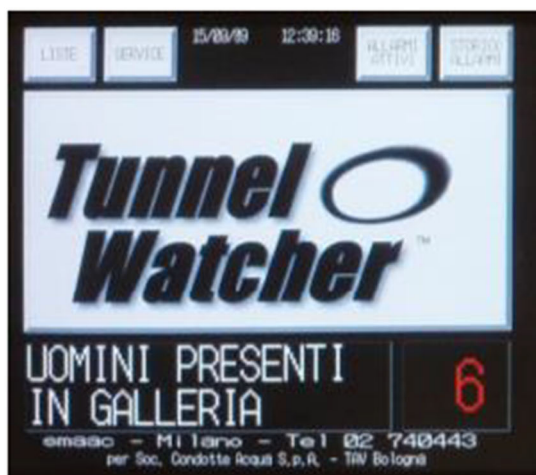
Figura 10.1 – Esempio di display da posizionare fuori gallerie e pozzi
