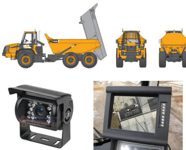
Figura 2.1 – Esempio di telecamera e monitor installati sui mezzi di cantiere
