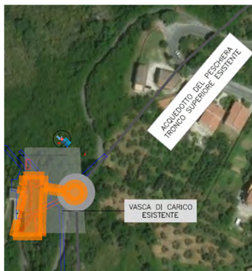
Figura 2.27 – Aree di cantiere vasca di carico
