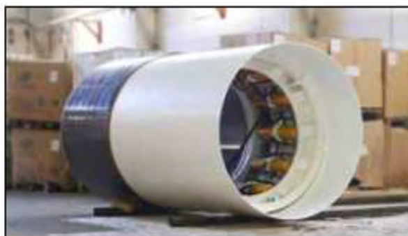
Figura 2.39 – Immagine stazione di spinta intermedia (da UNI-PdR 26.02.2017)
