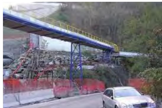
Figura 7.20 – Esempio di nastri trasportatori esterni per bordo strada e attraversamenti fluviali
