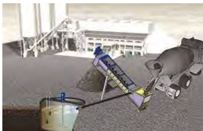
Figura 7.17 – Impianto di lavaggio betoniere
