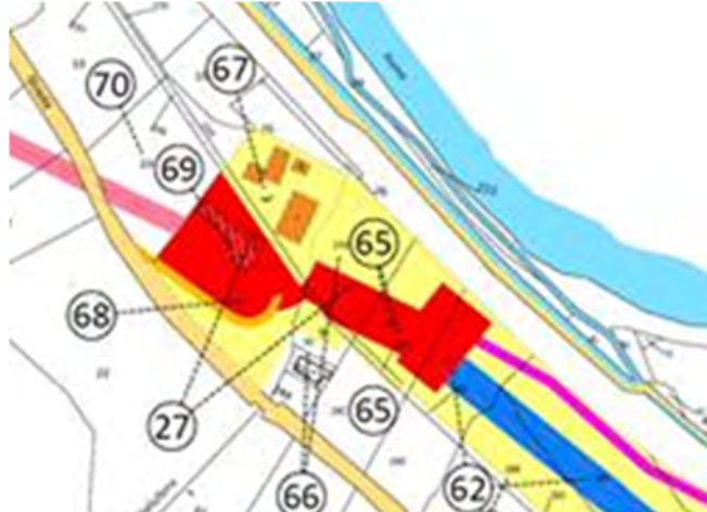
Figura 6.18 – Interferenza edifici esistenti presso uscita galleria Ponzano
