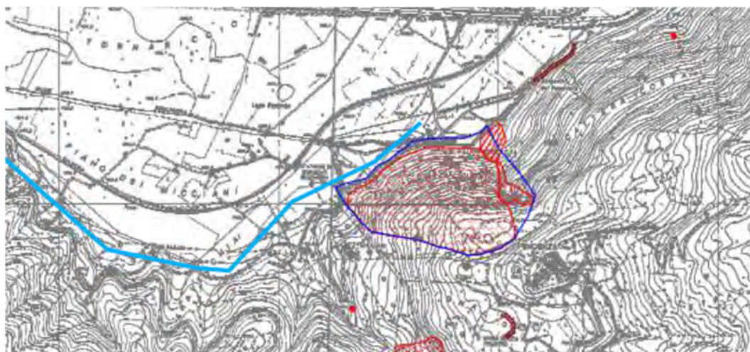
Figura 6.19 – Zone soggette ad instabilità gravitativa censite dal PAI nel settore in cui ricade il versante delle Sorgenti del Peschiera (DGPV). La linea azzurra rappresenta una porzione del tracciato di progetto.
