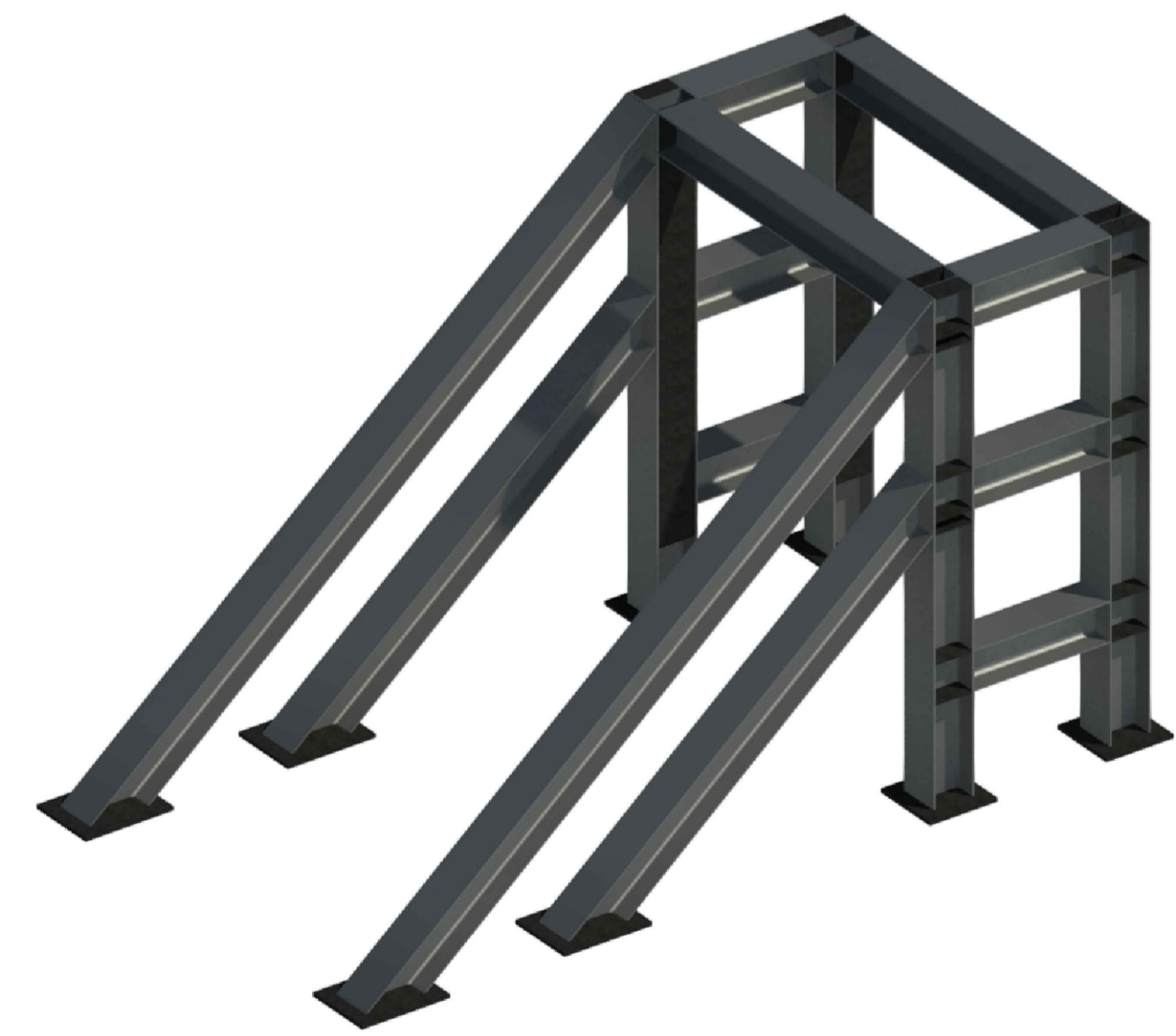
PARTICOLARE 3D DEL SISTEMA DI CONTRASTO IN ACCIAIO PER LA SPINTA DEL MICROTUNNELING
