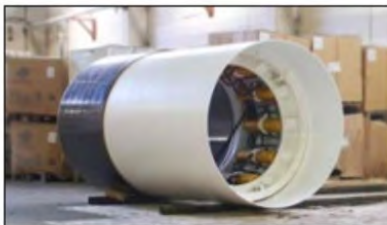
Figura 10 Restituzione fotografica di stazione di spinta intermedia
