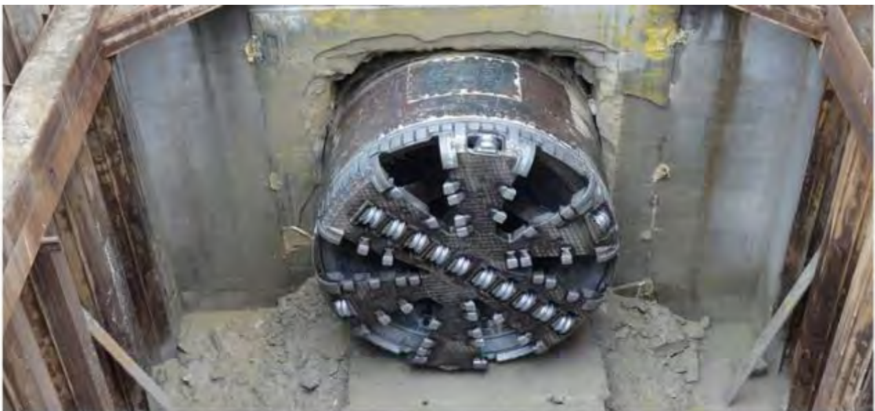
Figura 11 Testa di scavo per terreni misti
