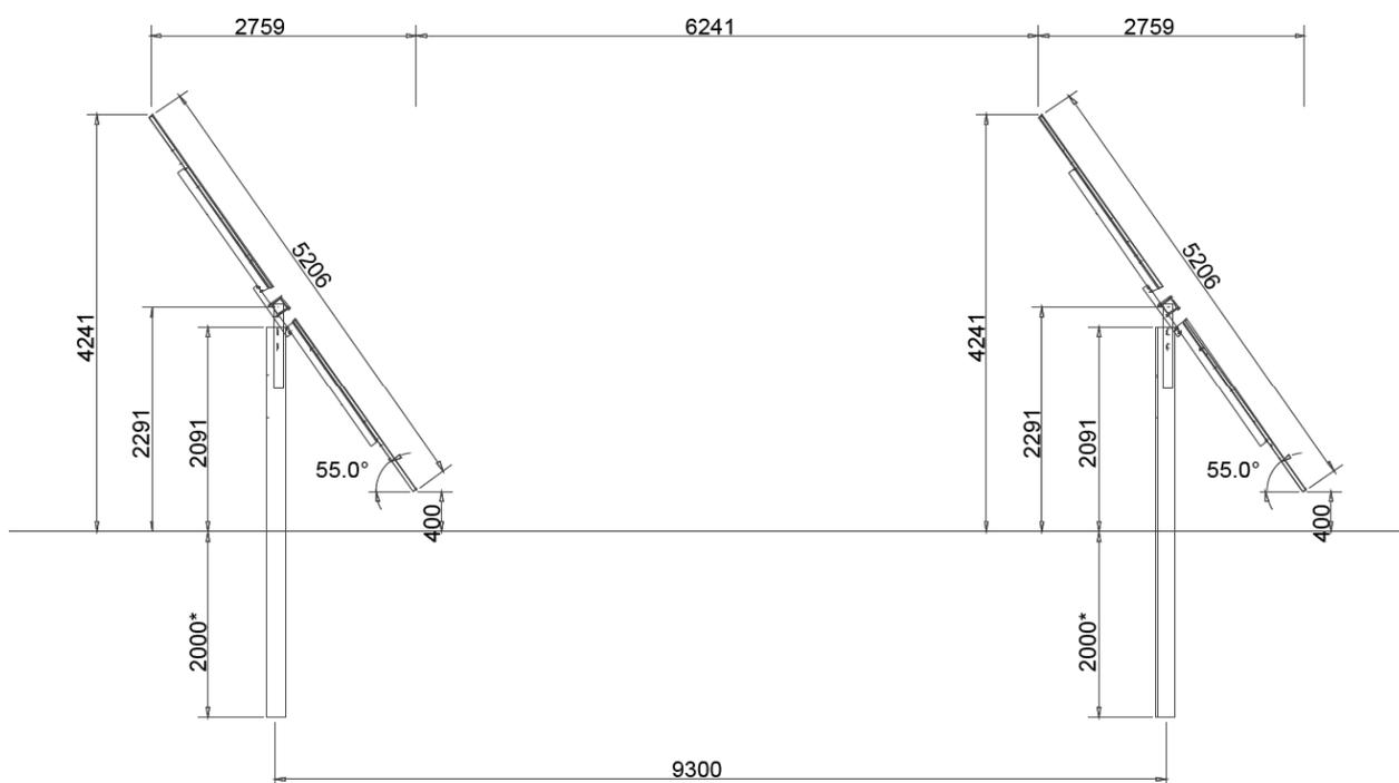
**Figura 4 - Struttura di supporto con distanza tra i tracker.**
