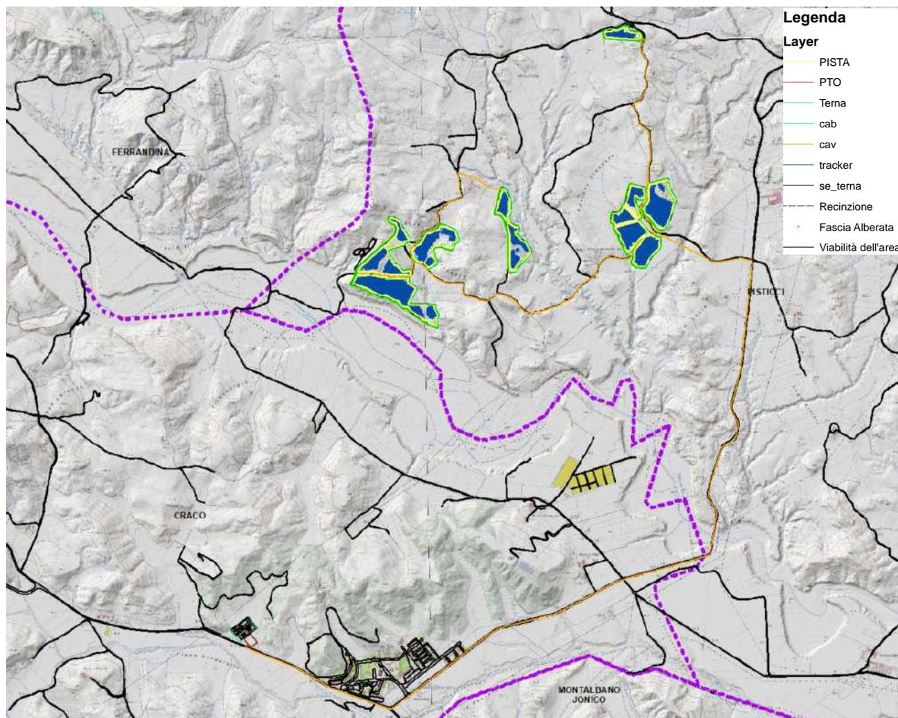
Figura 5.10. – Viabilità di accesso area sede impianto fotovoltaico
