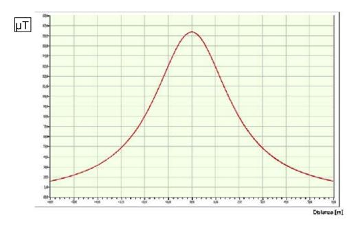
Dal quale si rileva che il valore di 3  $\mu T$  è a 5,1 metri dall'asse del piano di posa dei cavi.
