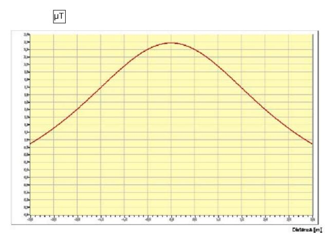
Dal diagramma si rileva che a 1 metro sul suolo la soglia dell'obbiettivo di qualità pari a 3  $\mu T$  è sempre rispettato risultando in asse linea il valore massimo pari a 2,5  $\mu T$ .
