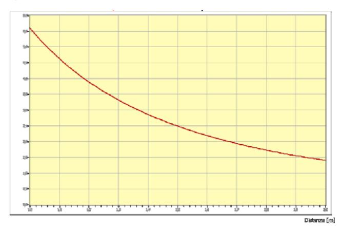
Dalle quali si rileva che la Dpa è a 0,89 m dall'asse linea e con fascia di rispetto +/-1 metri per il tratto con conduttore di 240 mm² ed è pari a 1,41 m dall'asse linea e con fascia di rispetto +/-1,5 metri per il tratto con conduttore di 630 mm².
