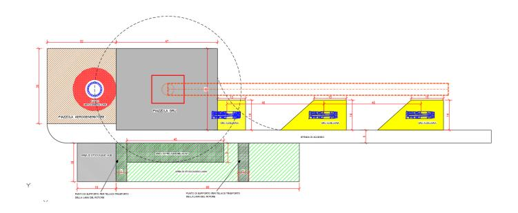
L'occupazione permanente consiste nella realizzazione della piazzola permanente dove verrà istallato l'aerogeneratore avente una dimensione di 35x32=1120 mg.
