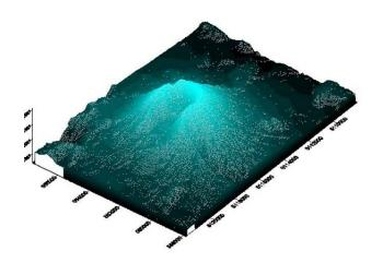
La creazione del DTM consente l'ottimizzazione dal punto di vista planoaltimetrico del tracciato; infatti, è possibile calcolare lungo lo sviluppo del tracciato, una volta fissati i parametri geometrici della strada (pendenza long., pendenza trasv., larghezza ecc.), i volumi di scavo e di riporto, nonché l'eventuale compenso necessario ad assicurare i parametri di progetto.
