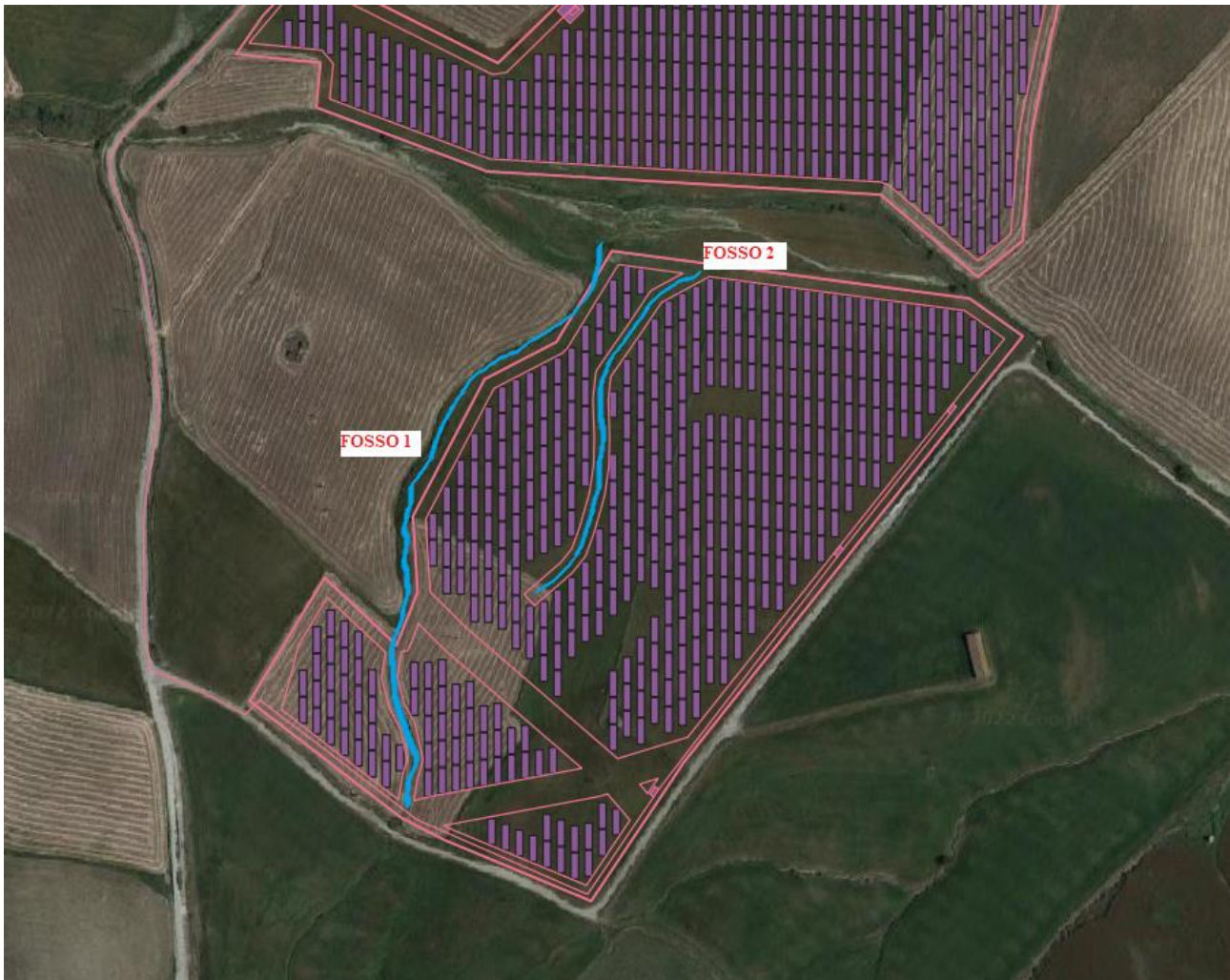
Figura 7-9 - Interferenza con fossi esistenti
