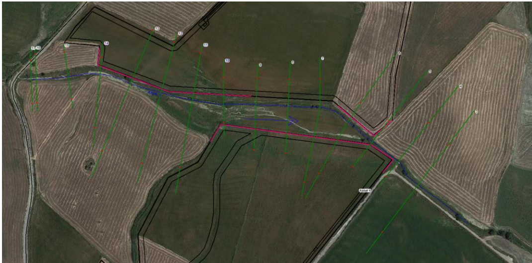
Figura 7-5 - Inserimento di arginello in terra a protezione delle aree di impianto. In rosso i tratti di sviluppo dell'opera
