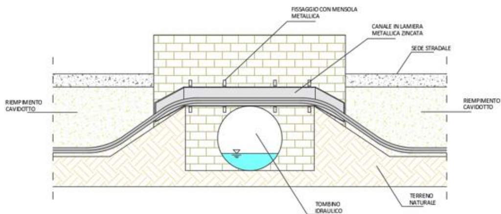
Figura 5-4- Sezione tipo di attraversamento mediante staffatura
