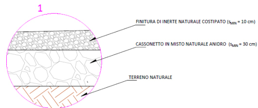
PARTICOLARE 1 - STRUTTURA STRADALE SCALA 1:25
