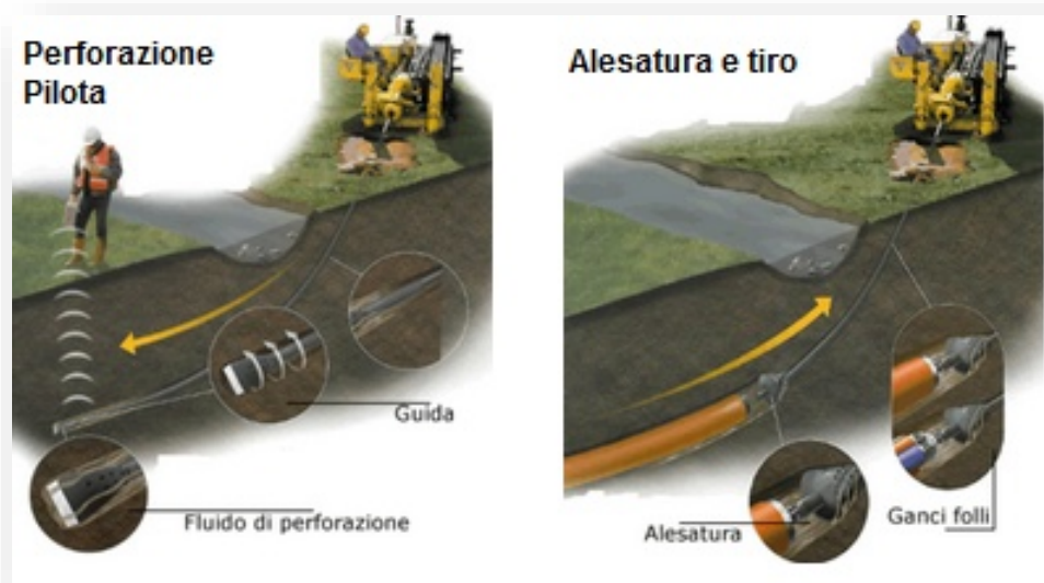
Figura 21 - Tecnologia di trivellazione orizzontale controllata (TOC)
