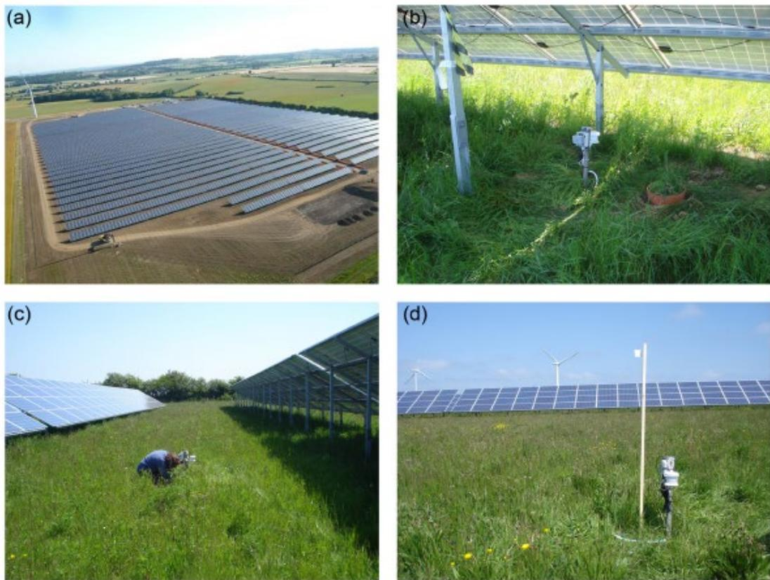
Figura 21 - (a) foto aerea del Westmill Solar Park; (b) Under: punto di rilevamento sotto i moduli; (c); Gap: punto di rilevamento tra i filari di moduli; (d) Control: punto di rilevamento esterno
