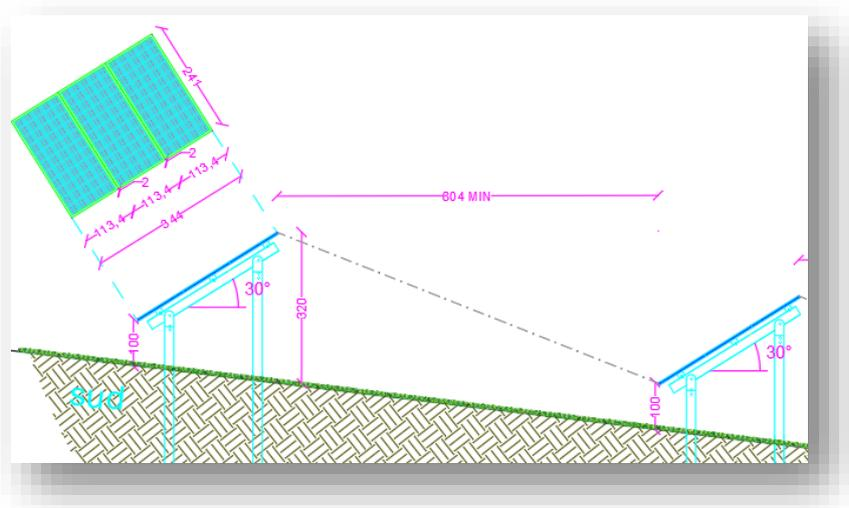
Figura 3 – Sezione tipo impianto con sistema fisso
