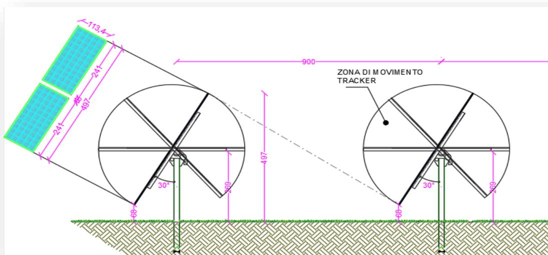
Figura 2 - Sezione tipo impianto con installazione su sistema ad inseguimento solare tipo tracker
