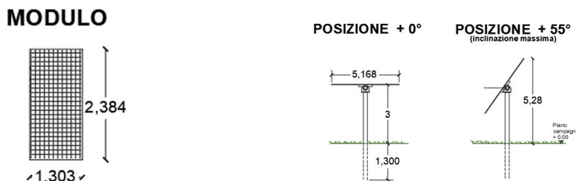
Figura 6.1 - Sezione Tracker, dimensioni in metri
