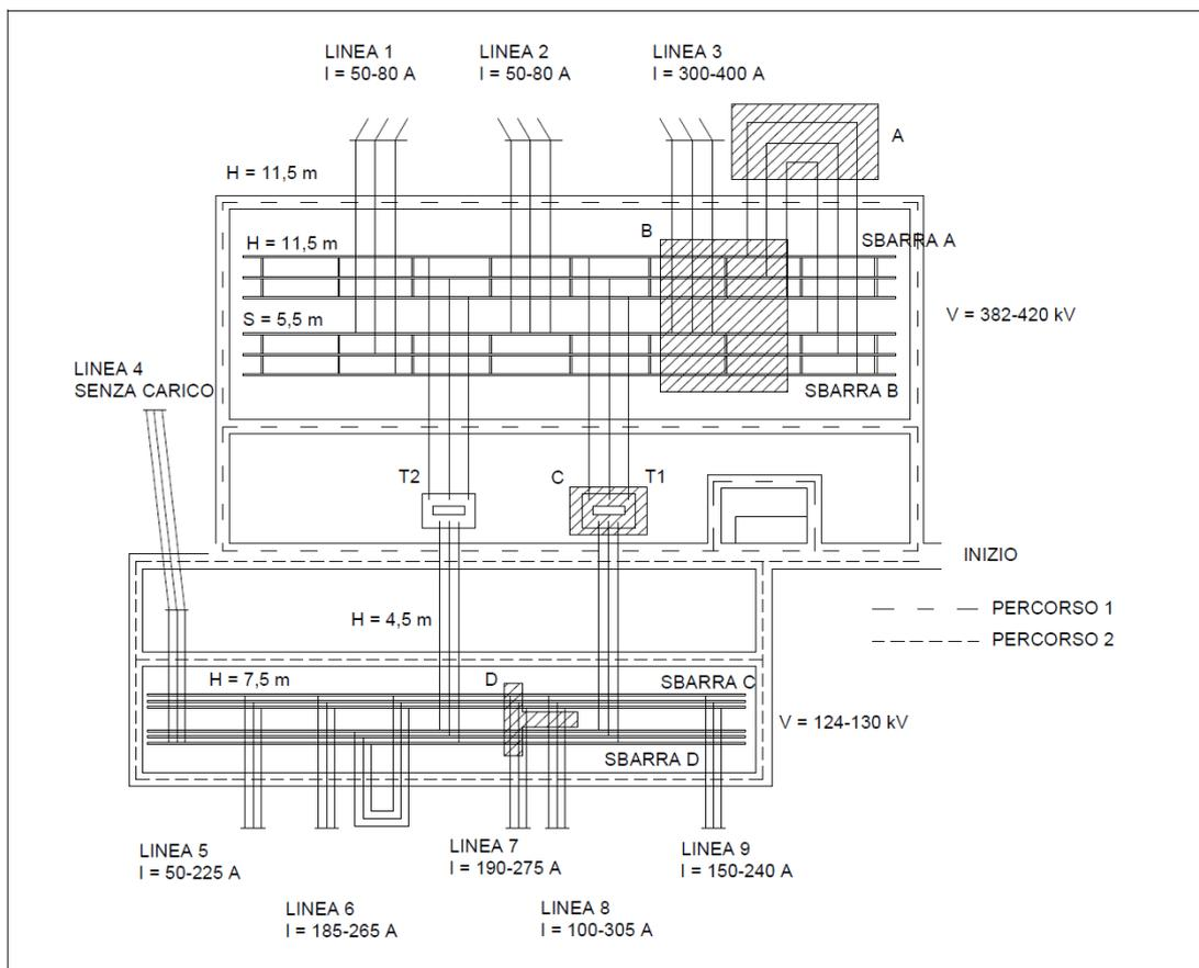
**Figura 9** Pianta di una tipica stazione 380/132 kV con l'indicazione delle principali distanze fase-fase (S) e fase-terra (H) e delle variazioni delle tensioni e delle correnti durante la fasi di misurazioni di campo elettrico e magnetico.
