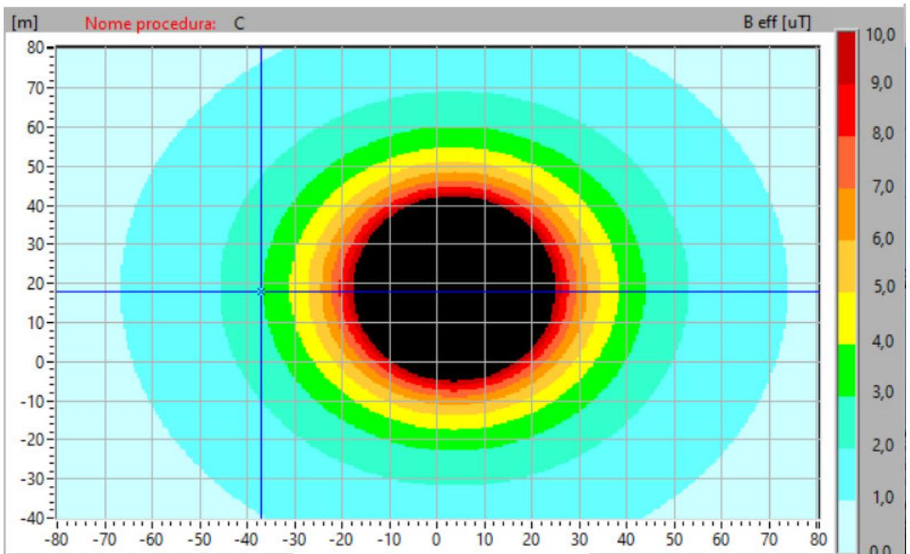
**Fig.3 Grafico del campo magnetico a quota conduttori**
