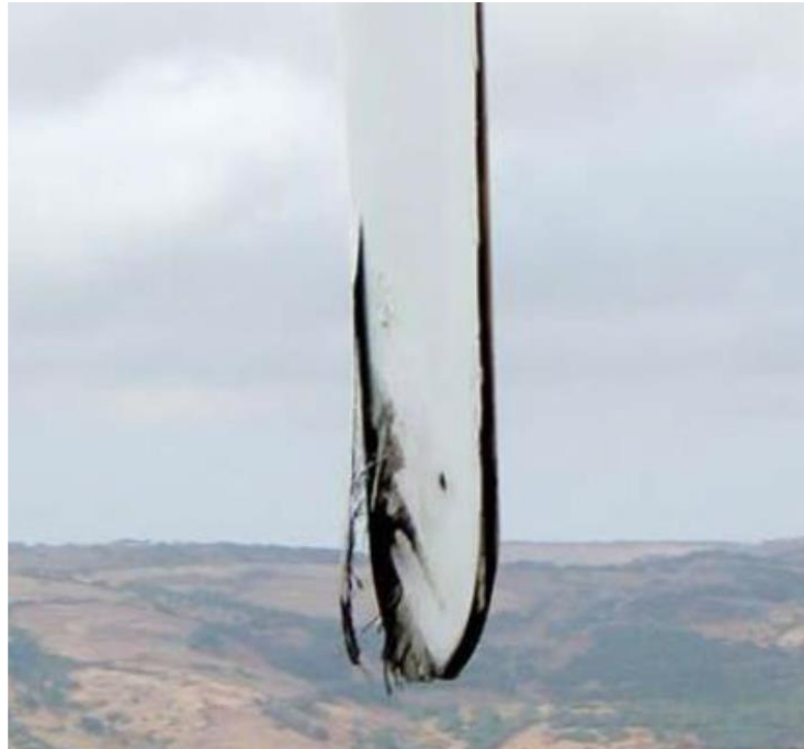
Figura 1 - Estremità della pala danneggiata da fulminazione atmosferica
