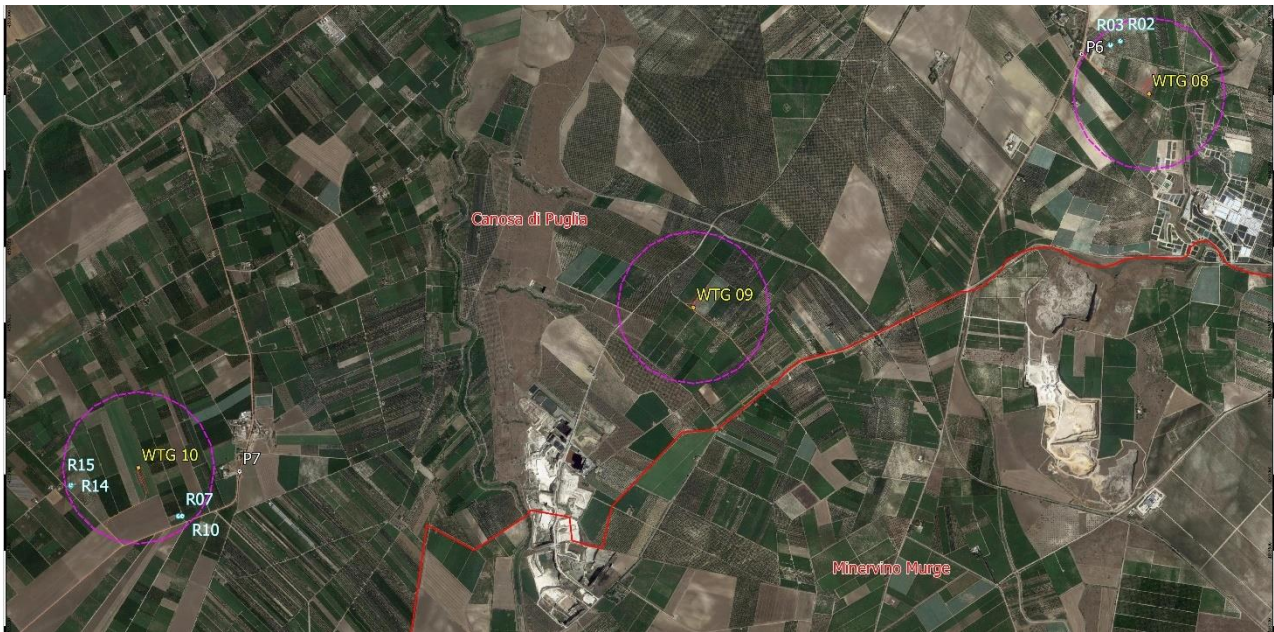
Figura 6: Zona d'impianto con individuazione di punti di misura (P) e recettori (R) considerati nella stima previsionale di emissione delle turbine di progetto (WTG) proposta nella versione ortofotografica satellitare – Area di impianto nel Comune di Canosa di Puglia
