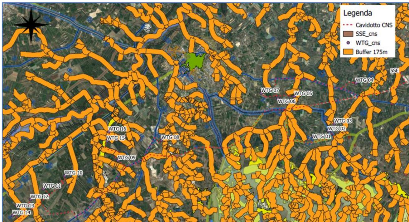
Figura 22 - Ipotesi di layout a 16 aerogeneratori - analisi vincolistica e buffer dai canali
