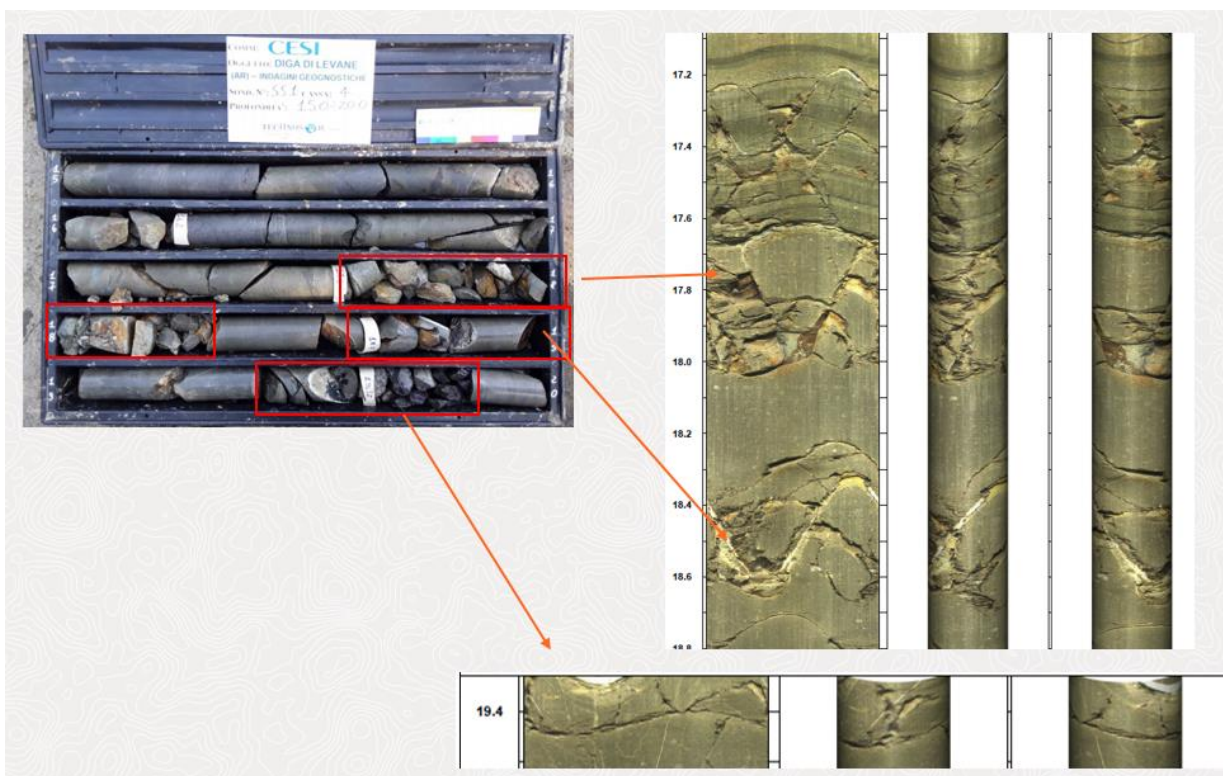
Figura 9.20 - SS1 intervalli 17.2-18m, 18.3-18.6m, 19.3-19.5m da p.c. (stratificazione+fratture).
