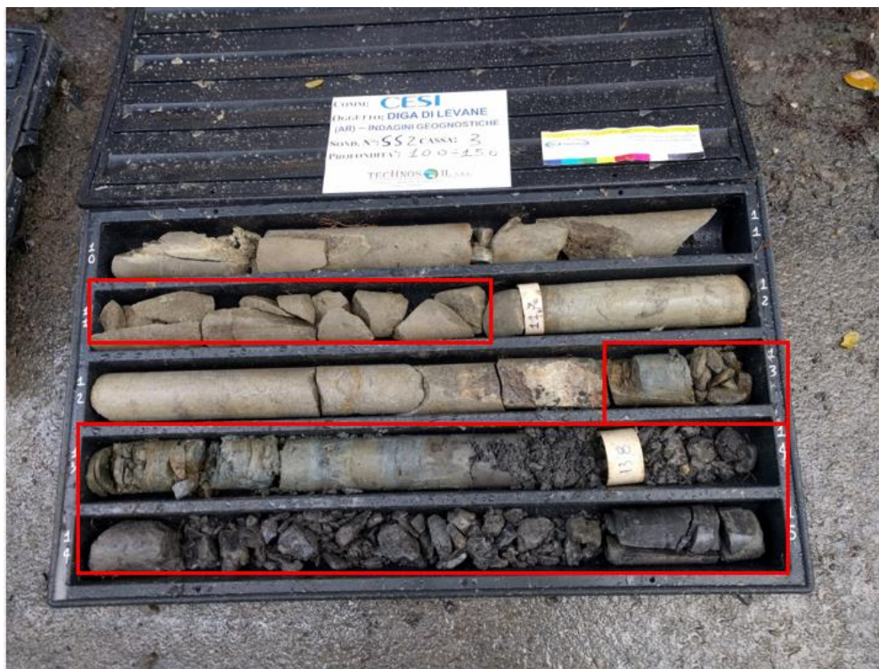
Figura 9.25 – SS2 intervalli fratturati 11-11.7m, 12.8-15m da p.c..
