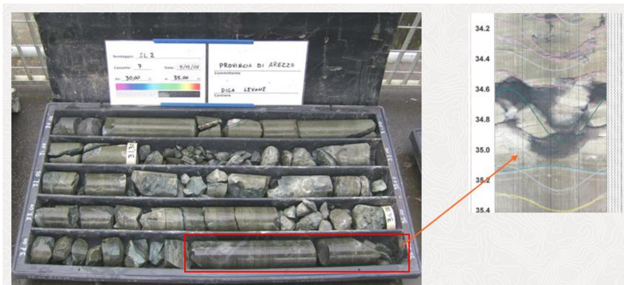
Figura 9.32 - SL2 intervallo 34.5-35m da p.c. indicante un probabile fenomeno di dissoluzione non evidente in carota.
