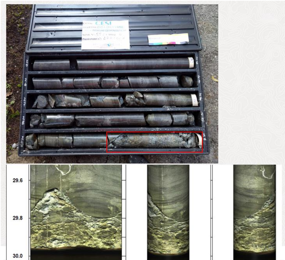
Figura 9.28 – SS2 intervallo da 29.5-29.9m da p.c. (breccia tettonica).
