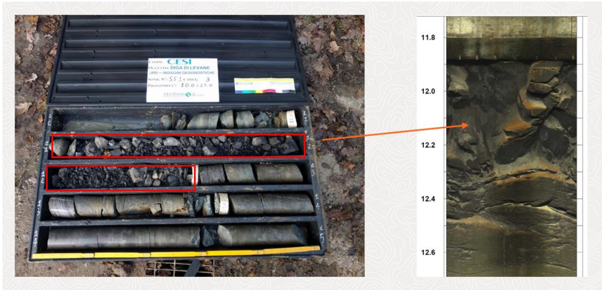
Figura 9.19 – SS1 intervallo 11.8-12.3m da p.c. (livello caotico).
