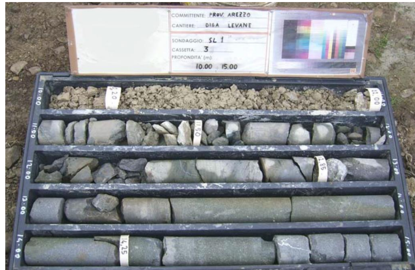
Figura 6.10 – Il sondaggio SL1 ha incontrato il substrato roccioso a partire da 11m di profondità.
