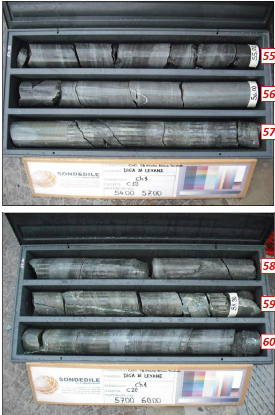
Figura 9.47 – Foto delle cassette catalogatrici del sondaggio CH1 fra 54 m e 60 m da p.c..
